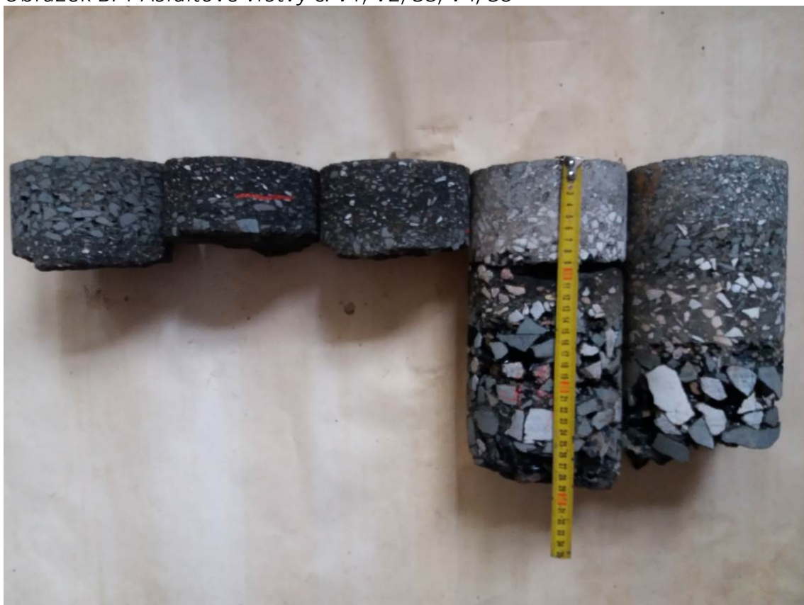
Obrázek B. 1 Asfaltové vrstvy č. V1; V2; S3; V4; S5
